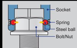
Die zwei Kugeln in der 6-kant Öffnung unserer NUT GRIP Steckschlüssel halten die Schraube sicher im Steckschlüssel. Dies erlaubt ein Arbeiten auch an schwer zugänglichen Stellen.
